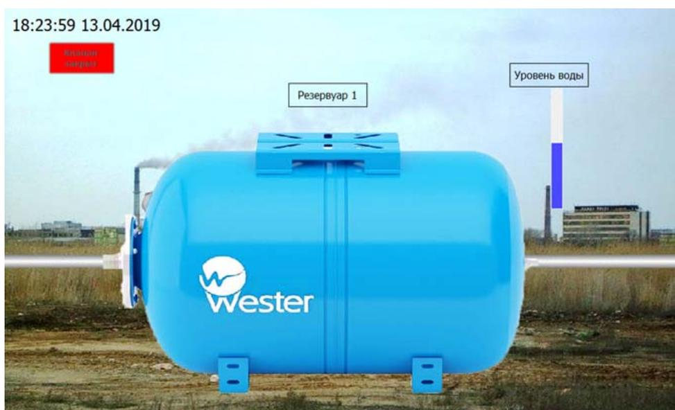
Рис. 2. Интерфейс наполнения бака, созданный в SCADA-системе Simp Light Free
